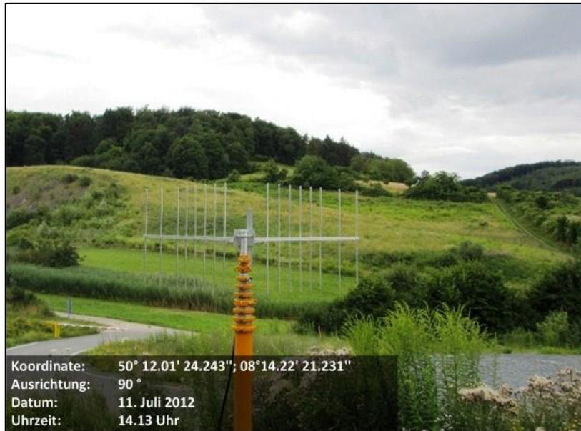
Abbildung 5: Dokumentation Antennen-Blickrichtung (Panoramamessung)
