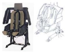
Der gepanzerte Sitz ist mit einer hochgezogenen Bodenwanne und seitlichem Schutz versehen.
