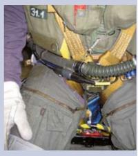
2 Beatmungsschlauch rechts und links der Kupplung anfassen, zusammendrücken und drehen
