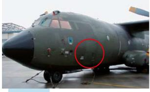
Die vordere Ausstiegsluke befindet sich am linken Teil des Rumpfs, seitlich versetzt hinter dem Cockpit.
