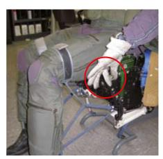
Auslösehebel zum Lösen der Beinrückholbänder nach oben ziehen und Beinrückholgurte trennen.
