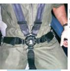
Die Gurte der Crew werden durch eine Drehung des Zentralschlosses geöffnet.
