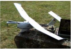
ALADIN (abbildende luftgestützte Aufklärungsdrohne im Nächstbereich) wird durch einen Elektromotor angetrieben und liefert echtzeitnahe Aufklärungsergebnisse aus dem Nächstbereich mittels abbildender Sensoren.
