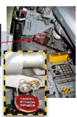
2. Das Kabinendach kann zusätzlich aufgesprengt werden. Der Sicherungsstift (rechte Konsole, vorne rechts im vorderen Cockpit) ist mit »MDC« gekennzeichnet und ist im Rahmen des linken Kabinendaches zu stecken.
