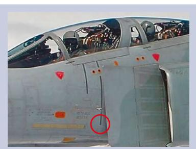
Zur Nutzung die Klappe am Ende des langen grauen Farbstreifens eindrücken und den dann sichtbaren Betätigungsschalter drücken. Die Leiter fährt nach unten aus.
