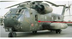
Hinter dem Cockpit befindet sich auf der linken Seite ein Notzugang. Vorsicht bei eingebautem Maschinengewehr!
