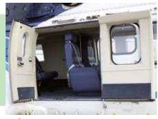
Zum Öffnen des rechten Türflügels den Griff eindrücken und in Richtung OPEN drehen. Der rechte Türflügel lässt sich jetzt öffnen.
