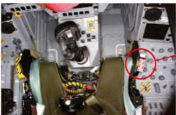
Sicherungshebel »SAFE / ARMED HANDLE« von »ARMED« in »SAFE« Position drehen!
