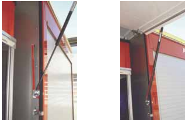
Abbildung 19a, b: Sicherung der Klappen vor dem Anbau der Zelte [Wenking, IdF NRW]
