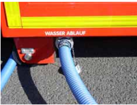
Abbildung 15a, b: Anschluss Abwasser; links: Container; rechts: Abwasserpumpe [Wenking, IdF NRW]
