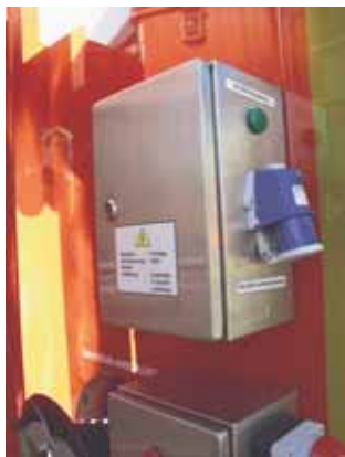
Abbildung 12: Fremdeinspeisung 230 V [Wenking, IdF NRW]
