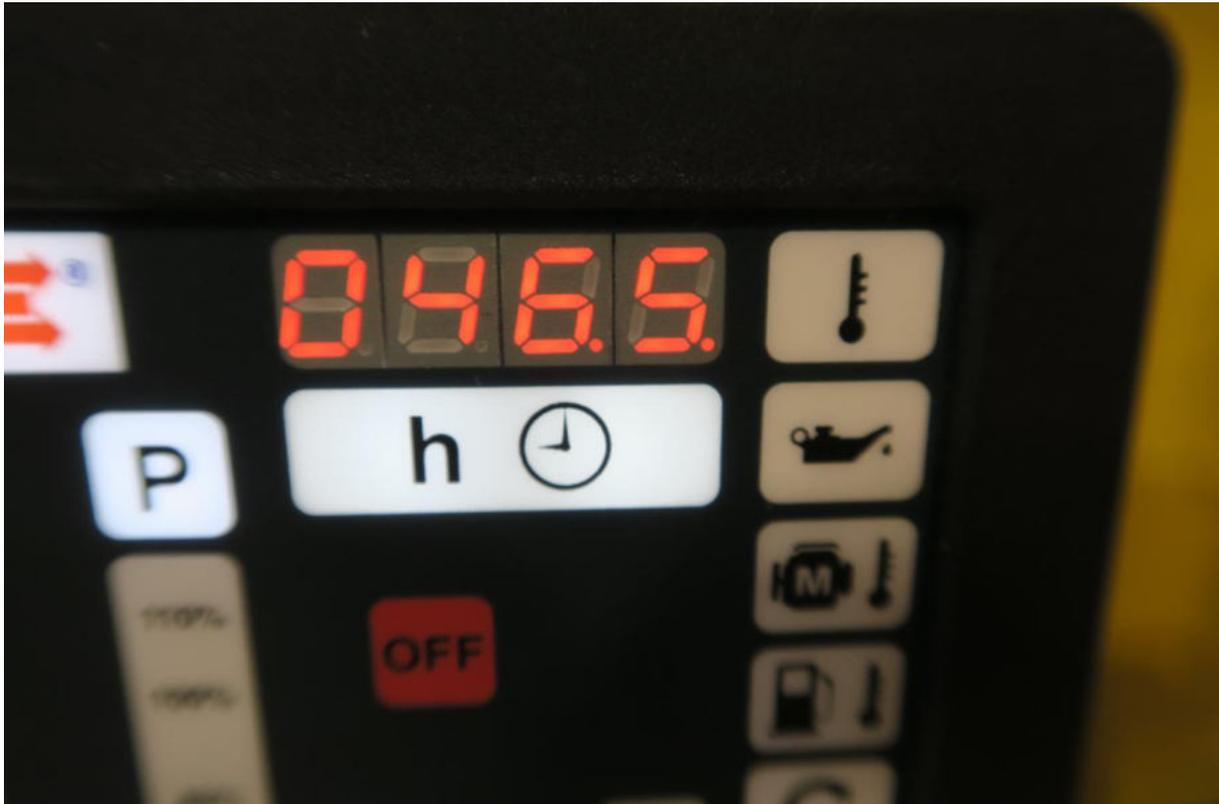
Foto 31: Ansicht Betriebsstunden tragbarer Stromerzeuger
