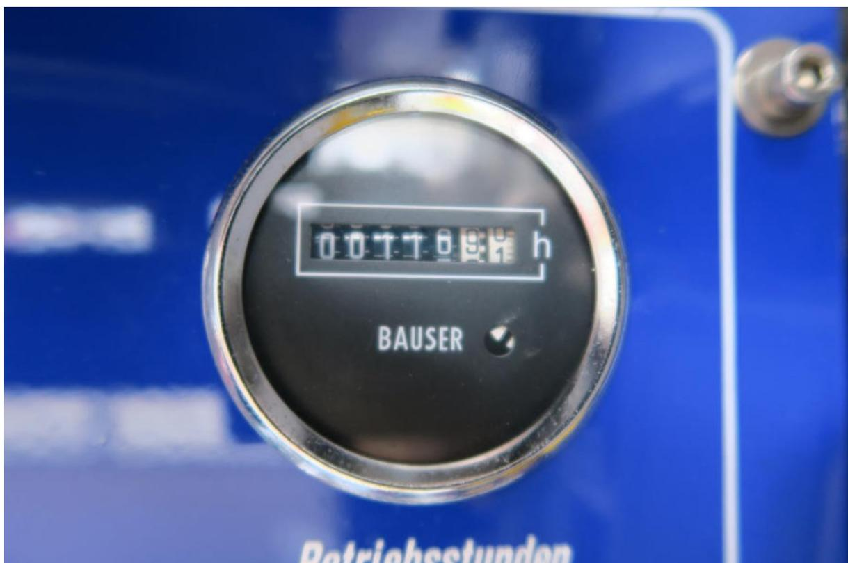
Foto 8: Betriebsstundenzähler Feuerlöschkreiselpumpe
