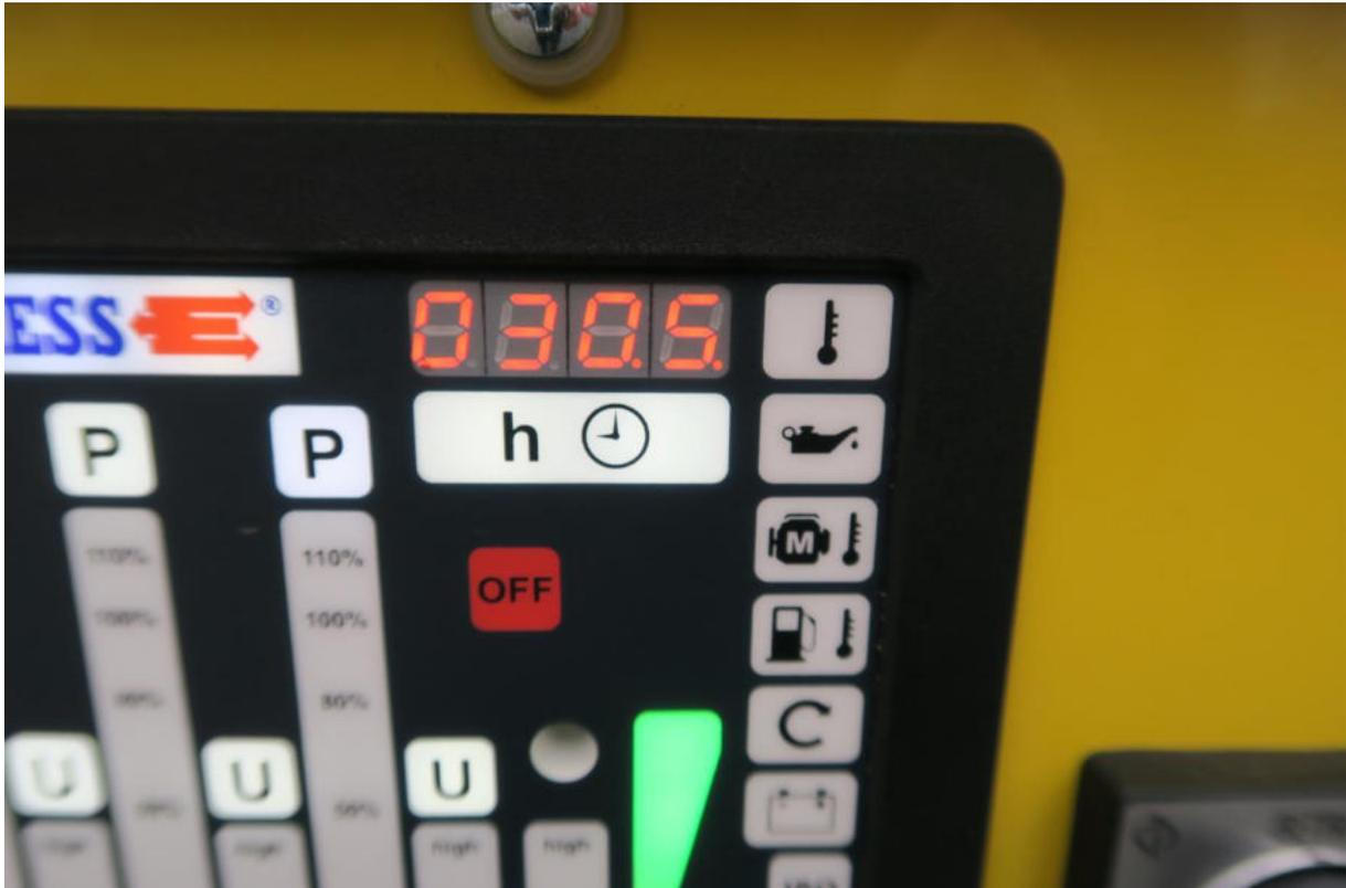
Foto 33: Ansicht Betriebsstunden tragbarer Stromerzeuger
