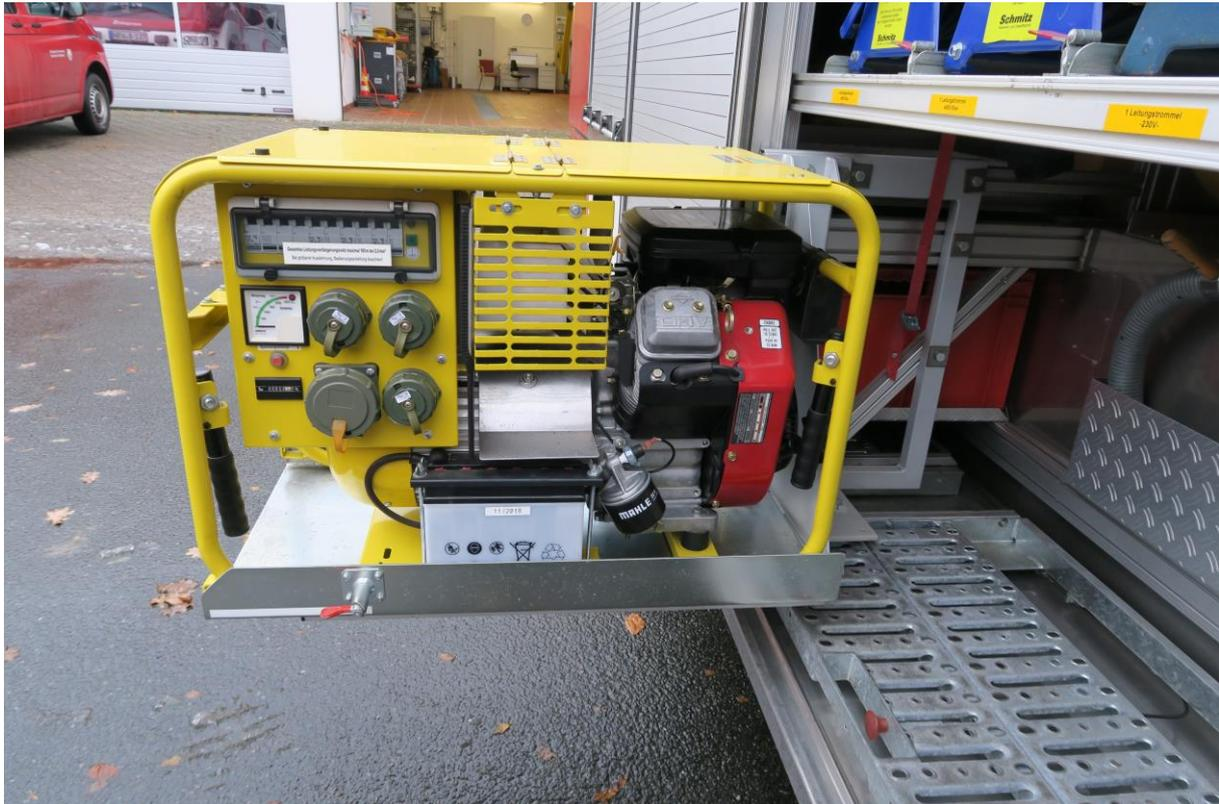
Foto 23: Ansicht schwenkbare Lagerung Stromerzeuger
