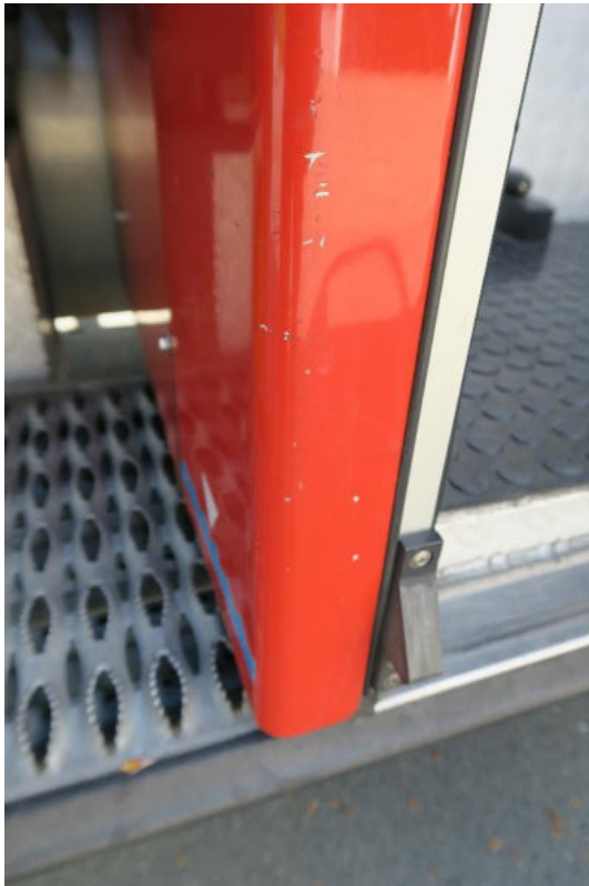
Foto 47: Lackschäden Geräteraum Aufbau
