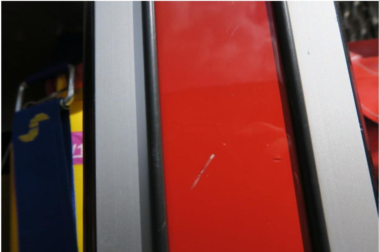
Foto 41: Lackschäden Geräteraum Aufbau (tlw. nachlackiert)
