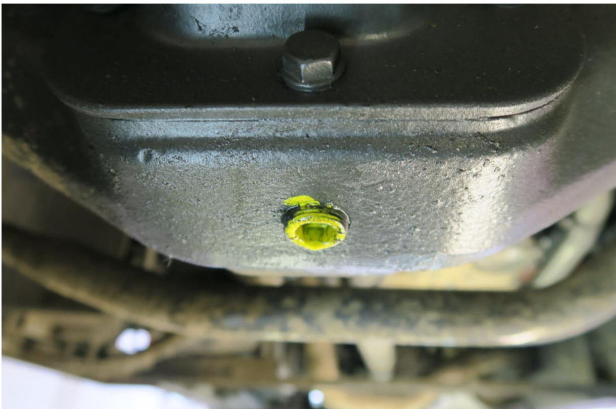
Foto 38: Vorderachsdifferential leicht ölfeucht
