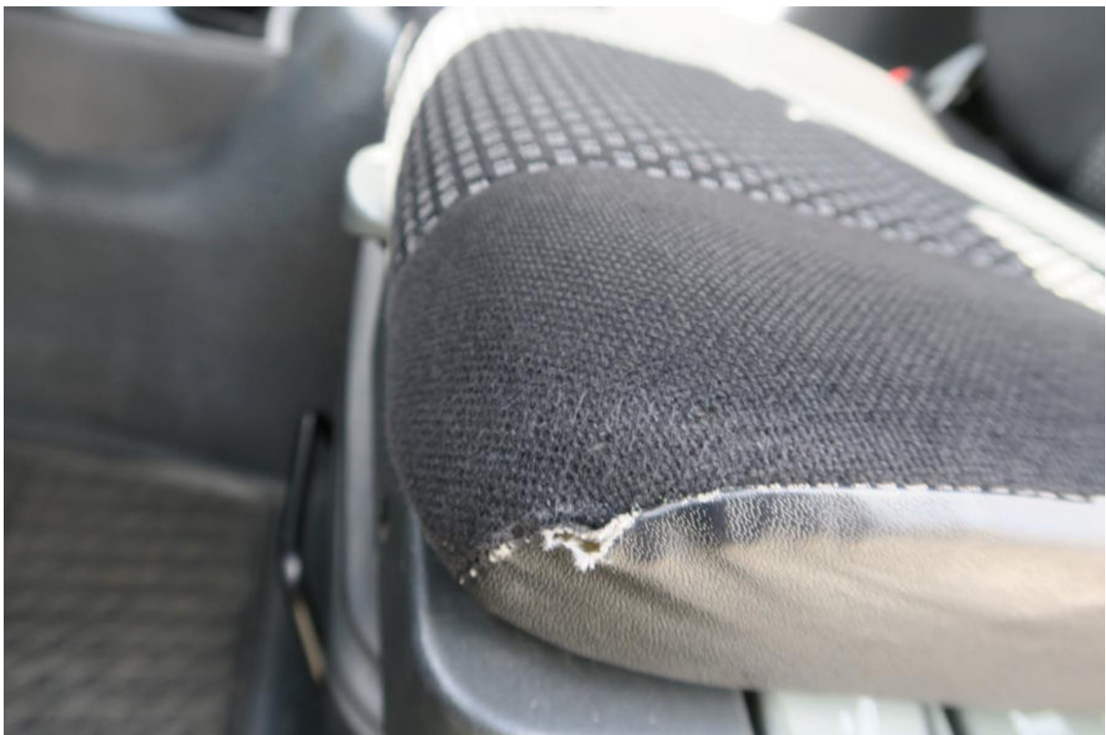
Foto 52: Naht Fahrersitz leicht beschädigt
