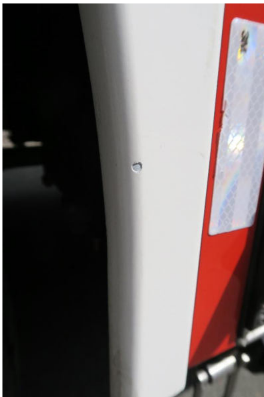
Foto 42: Lackschaden Kotflügel (nachlackiert)
