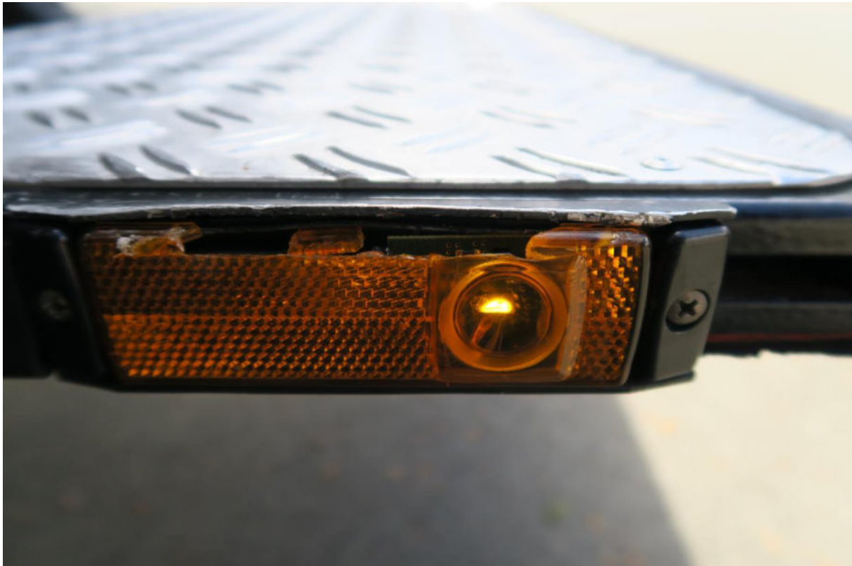
Foto 53: Blinkleuchte Traversenkasten beschädigt
