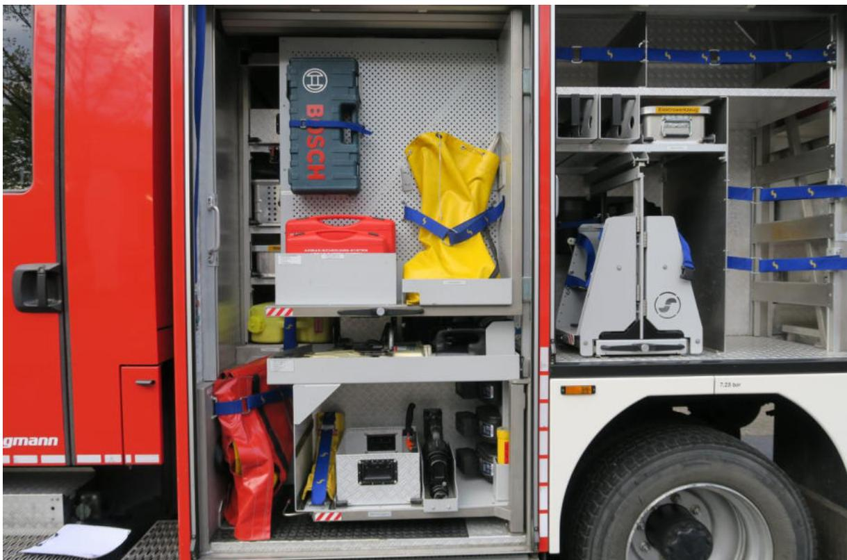
Foto 16: Ansicht Geräteraum 1, Vorderseite Schwenkwand
