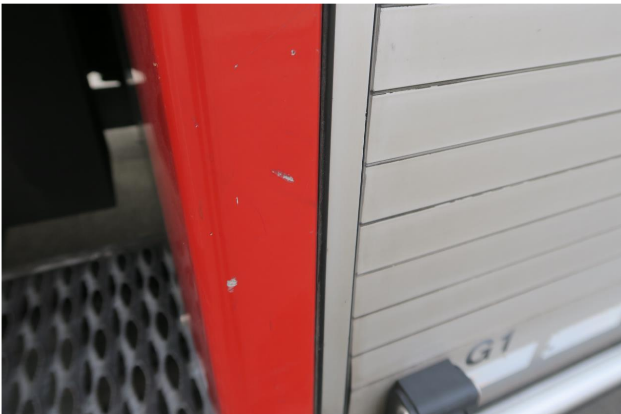
Foto 40: Lackschäden/ Kratzer Geräteraum 1
