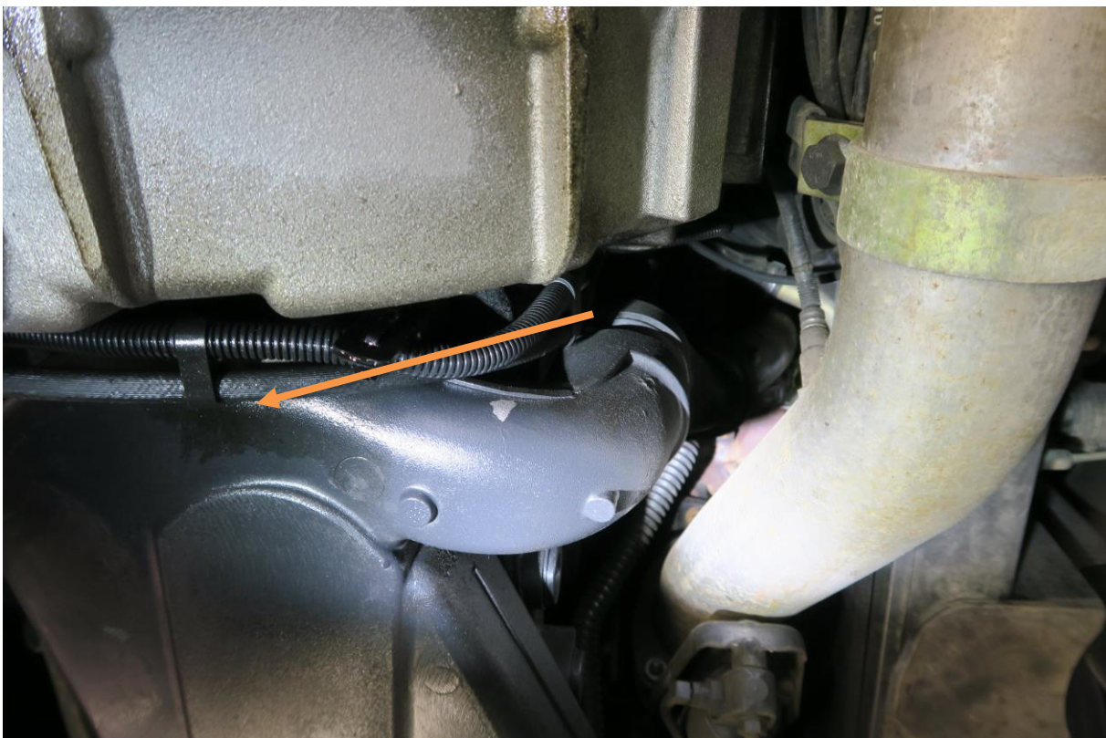
Foto 44: Motor leichter Ölverlust
