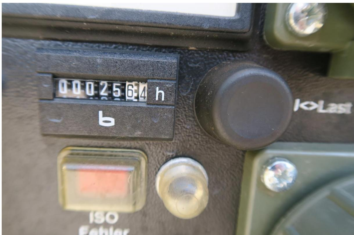
Foto 22: Ansicht Betriebsstunden tragbarer Stromerzeuger
