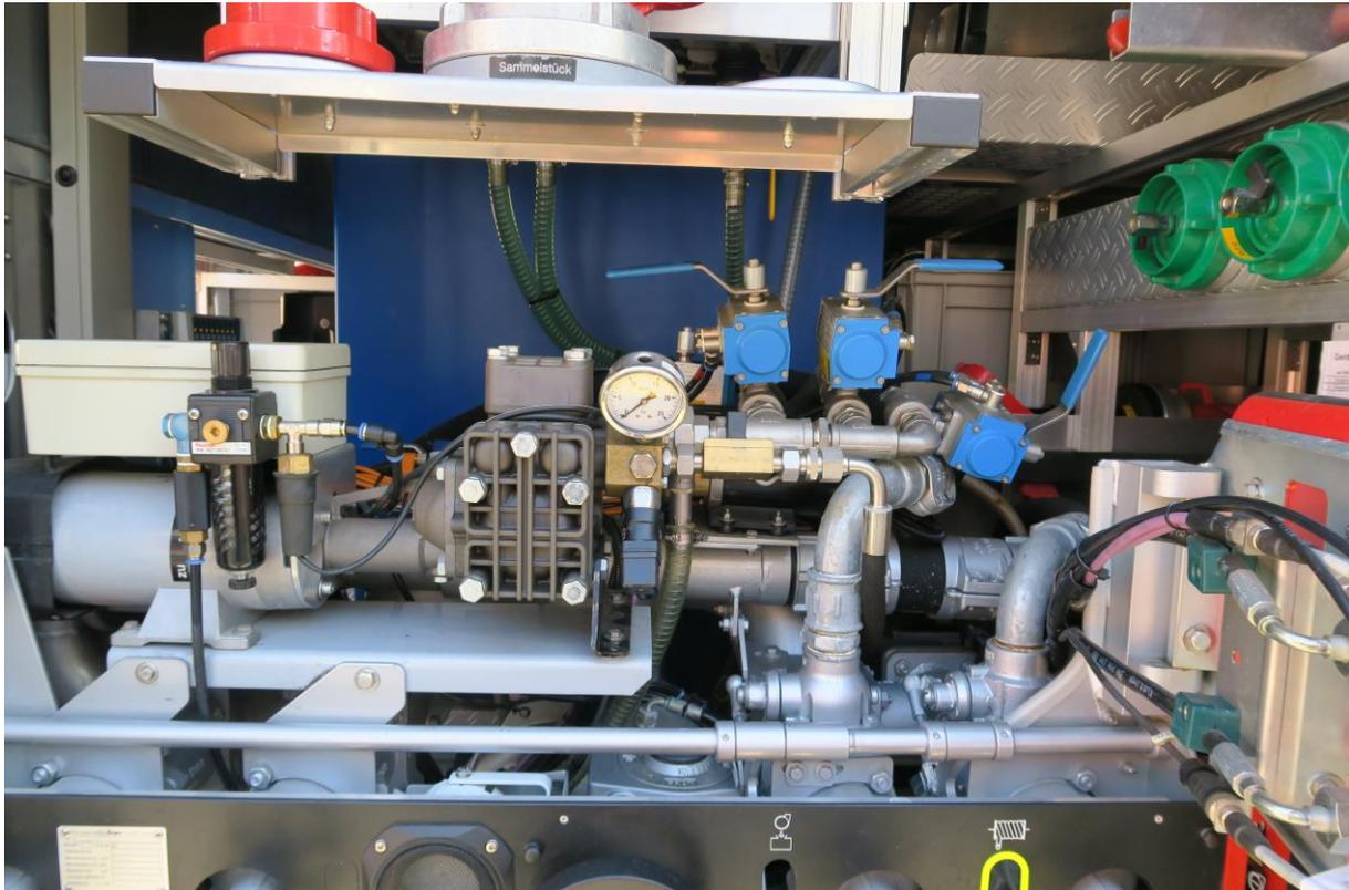
Foto 27: Ansicht Feuerlöschkreiselpumpe und Druckzumischanlage
