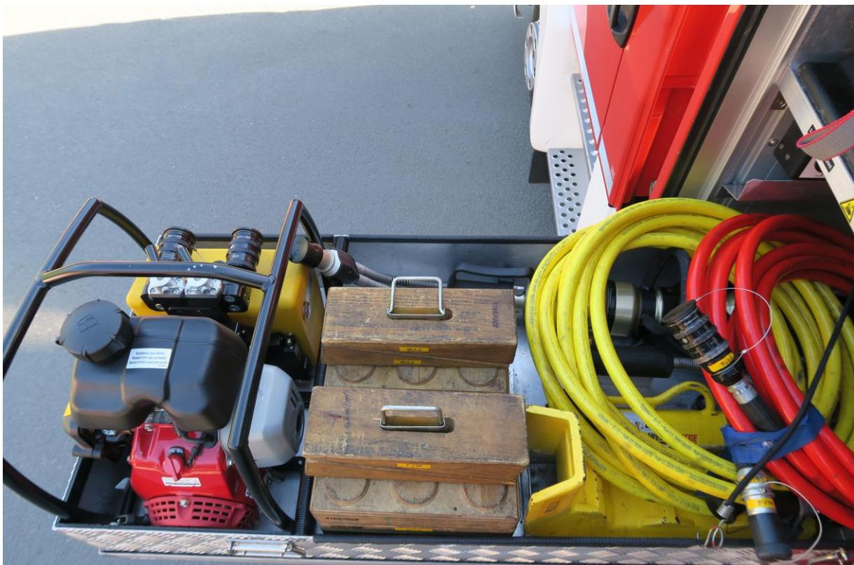
Foto 16: Ansicht Geräteraum 1, Auszug hydraul. Rettungsgerät
