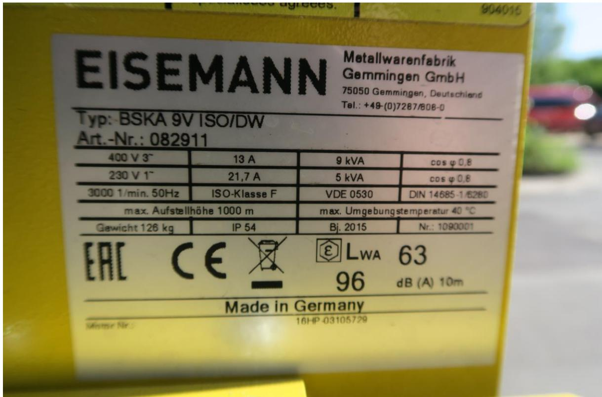
Foto 21: Typenschild Stromerzeuger
