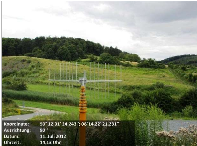
Abbildung 5: Dokumentation Antennen-Blickrichtung (Panoramamessung)
