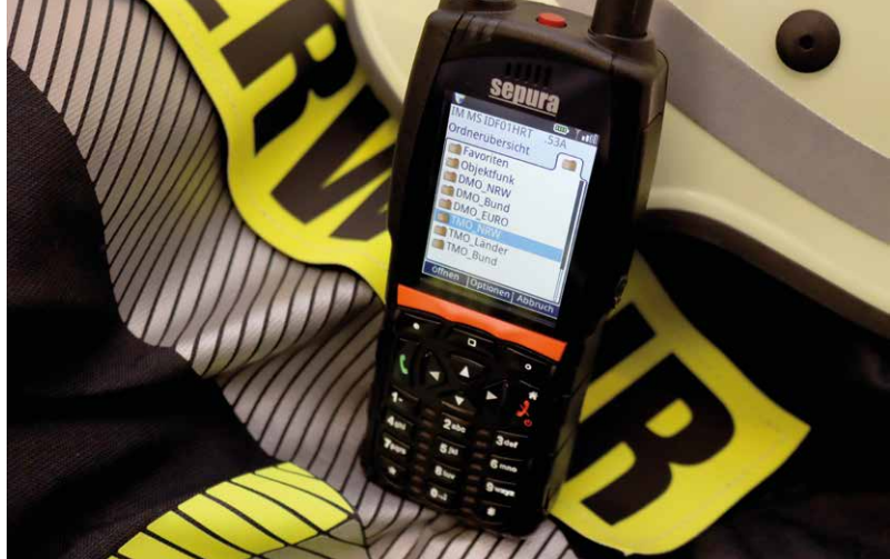
Am Kompetenzzentrum Digitalfunk wird jährlich die Musterprogrammierung für die verschiedenen Typen von Motorola- und Sepura-Digitalfunkgeräten erstellt. Diese dient als Grundlage für die Programmierung aller Digitalfunkgeräte im Land und gewährleistet eine einheitliche Art der Bedienung.
